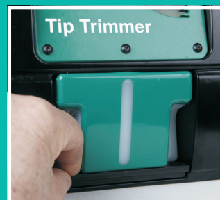
Wolframstøvet fjernes let uden spild fra maskinens forside.
