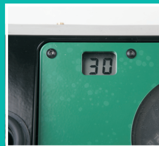
Slibevinklen indstilles let, ved hjælp af den digitale udlæsning.
